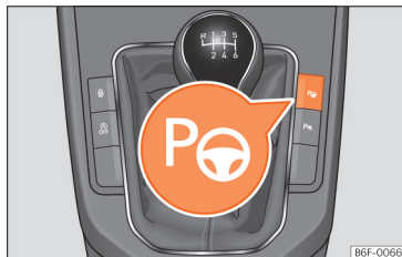
Slika 123 V sredinski konzoli: tipka za vklop parkirne asistencije s krmilno avtomatiko
