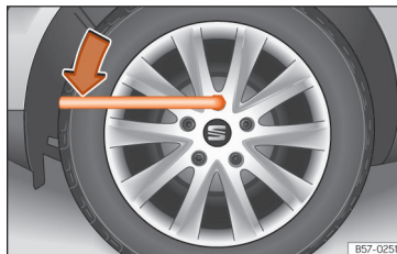
Slika 195 Menjava kolesa: odvijanje kolesnih vijakov.
