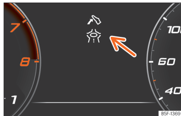
Slika 100 Prikaz asistenčnega sistema za varčno vožnjo (shematski prikaz).
