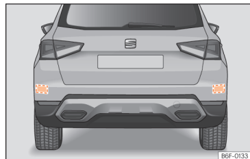
Slika 95 Območje za vozilom: območja radarskih senzorjev
