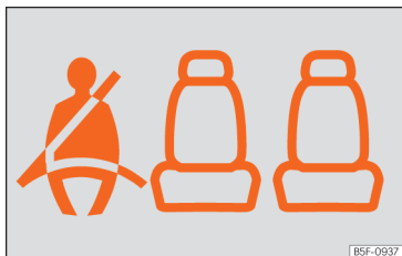
Slika 18 Kombinirani instrument: prikaz statusa varnostnih pasov na zadnjih sedežih.
