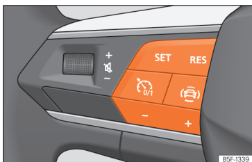
Slika 98 Na večfunkcijskem volanu: tipke za upravljanje tempomata.
