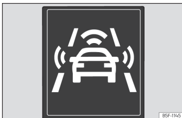
Slika 108 Na zaslonu kombiniranega instrumenta: prikaz predhodnega opozorila
