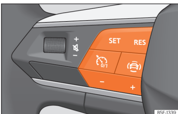
Slika 111 Na večfunkcijskem volanu: tipke za upravljanje tempomata.
