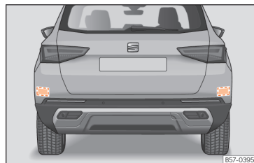
Slika 108 Območje za vozilom: območja radarskih senzorjev
