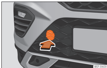
Slika 197 Na desni strani sprednjega odbijača: odstranjevanje obloge.
