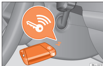
Slika 95 Na desni strani volana: zasilni zagon
