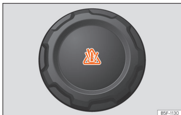
Stika 210 Prostor spredaj: pokrov ekspanzijske posode s hladilno tekočino.
