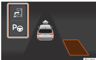
Slika 139 Na zaslonu kombiniranega instrumenta: vizualizacija parkirne asistencije s krmilno avtomatiko z miniaturnimi prikazi
