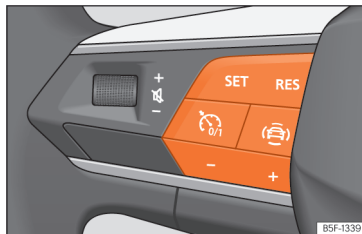
Slika 112 Na večfunkcijskem volanu: tipke za upravljanje omejevalnika hitrosti.
