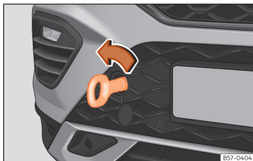
Slika 198 Sprednji odbijač desno: privito vlečno uho
