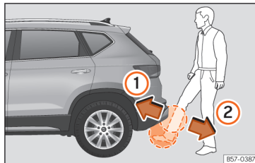
Slika 59 Senzorsko krmiljeno odpiranje vrat prtljažnika (Easy Open)
