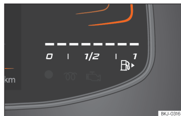
Slika 3 Osnovni kombinirani instrument: prikazovalnik količine goriva.
