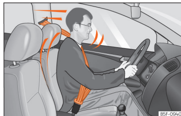
Slika 16 Pripet voznik, ki ga ob nenadnem sunkovitem zaviranju zadrži pravilno pripet varnostni pas.
