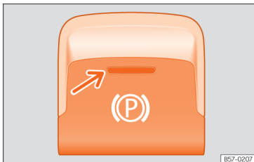
Slika 131 Sredinska konzola, spodnji del: tipka za elektronsko parkirno zavoro.
