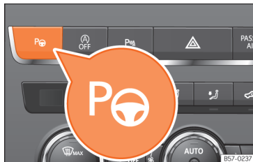
Slika 138 V sredinski konzoli, zgornji del: tipka za vklop parkirne asistencije s krmilno avtomatiko.
