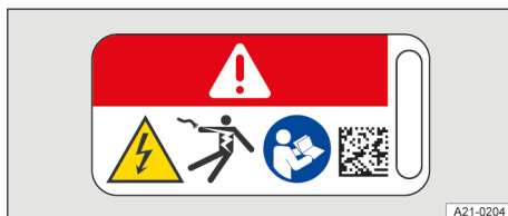
Sl. 5 Opozorilna nalepka na visokonapetostnih komponentah.
