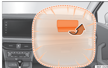
SL 15 Sovoznikova varnostna blazina v armaturni plošči.
