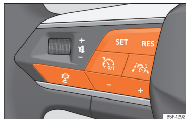
Sl. 160 Leva stran večfunkcijskega volana: tipke za upravljanje asistenc Travel Assist.
