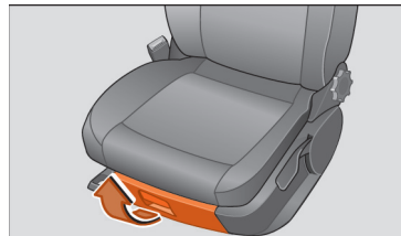
SL. 118 Predal pod desnim sprednjim sedežem. »
