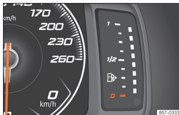
Sl. 67 Digitalni kombinirani instrument: prikazovalnik količine goriva.
