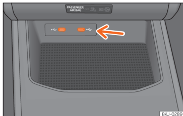
Slika 134 Sredinska konzola: USB-priključek.
