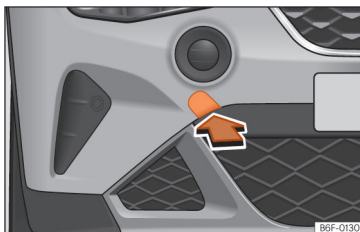
Slika 162 Na desni strani sprednjega odbijača: odstranjevanje obloge.
