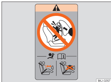
Slika 36 Nalepka z informacijami o varnostni blazini: na zadnjem okvirju sovoznikovih vrat.
