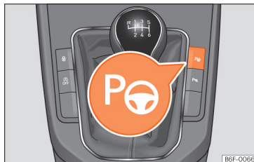
Slika 122 V sredinski konzoli: tipka za vklop parkirne asistence s krmilno avtomatiko
