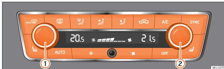
Slika 80 V vredstinski konzoli: enota za upravljanje Climatronica.
