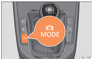
Slika 91 Poleg prestavne ročice: tipka MODE
