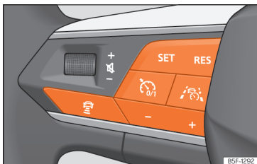
Slika 112 Leva stran večfunkcijskega volana
