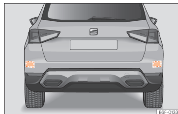
Slika 97 Območje za vozilom: območja radarskih senzorjev
