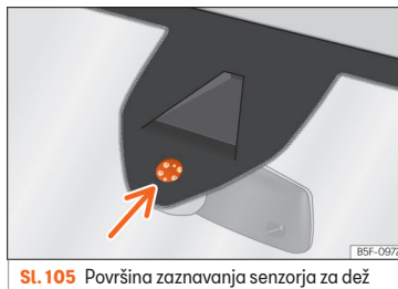
Sl. 105 Površina zaznavanja senzorja za dež
