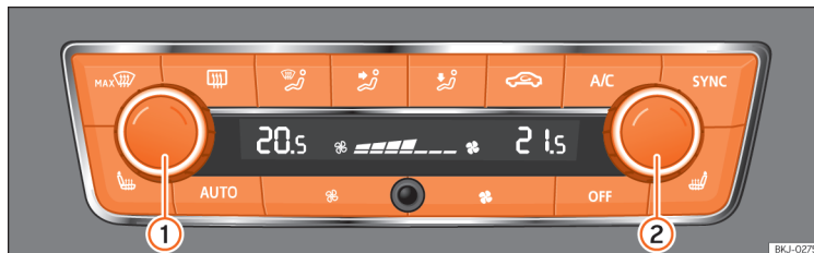
SL 126 V sredinski konzoli: elementi za upravljanje Climatronica
