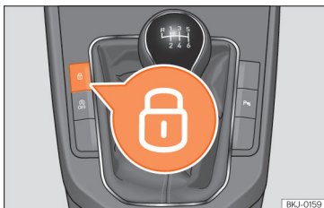
Sl. 87 Sredinska konzola: tipka centralnega zaklepanja
