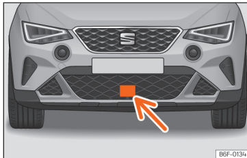
Sl. 139 V sprednjem odbijaču: radarski senzor
