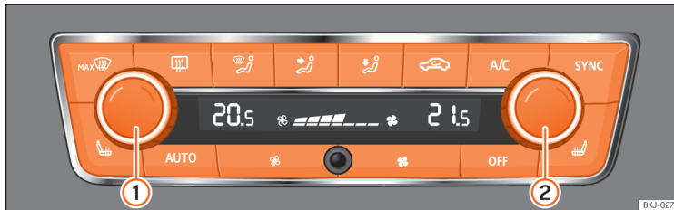
SL 119 V sredinski konzoli: elementi za upravljanje Climatronica
