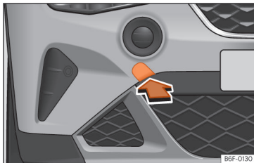
Sl. 44 Sprednji odbijač desno: snemanje obloge.
