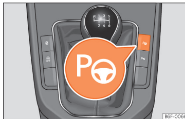
Sl. 163 V sredinski konzoli: tipka za vklop parkirne asistence s krmilno avtomatiko
