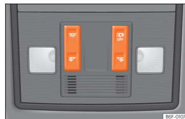
Sl. 97 Del stropne obloge: notranja osvetlitev spredaj
