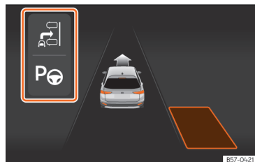
Sl. 185 Na zaslonu kombiniranega instrumenta: vizualizacija parkirne krmlilne asistencije z miniaturnimi prikazi.
