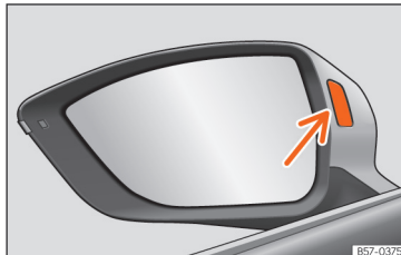
Sl. 177 Kontrolna lučka asistence za opozarjanje na vozila v mrtvem kotu.
