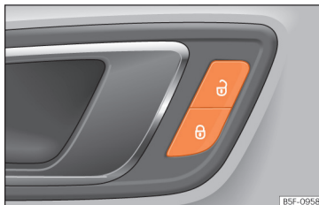
Sl. 79 Voznikova vrata: tipka za centralno zaklepanje.
