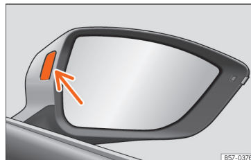
Sl. 178 Kontrolna lučka asistence za opozarjanje na vozila v mrtvem kotu.
