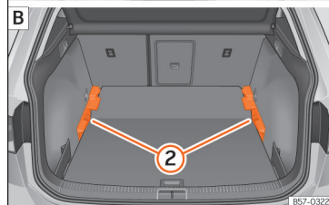
Sl. 119 Variabilno dno prtljažnika: A zgornji položaj; B spodnji položaj
