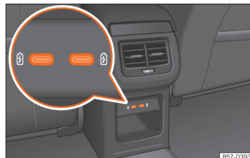
Sl. 147 Zadnji del sredinske konzole: USB-prikluček s funkcijo vtičnice.
