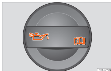
Sl. 213 V motornem prostoru: pokrov odprtine za dolivanje motornega olja v motornem prostoru.
