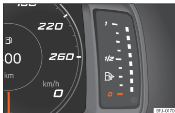
Sl. 60 Digitalni kombinirani instrument: prikazovalnik količine goriva.
