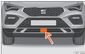
Sl. 157 V sprednjem odbijaču: radarski senzor
