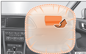
Sl. 15 Sovoznikova varnostna blazina v armaturni plošči.
