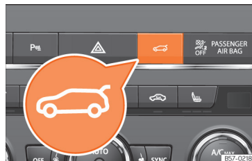
Sl. 88 Sredinska konzola: tipka za odpiranje in zapiranje vrat prtljažnika.
