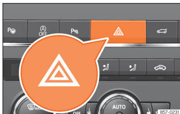
SL 99 Armatura plošča: stikalo za opozorilne utripalke
