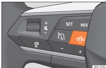
Sl. 66 Leva stran večfunkcijskega volana: tipka za asistenčne sisteme (odvisno od izvedbe).
