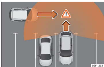
SL. 161 Shematski prikaz delovanja opozorila na prečni promet zadaj: zaznano območje okrog vozila, ki speljuje.
