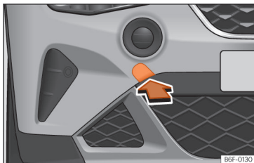
Sl. 44 Sprednji odbijač desno: snemanje obloge.
