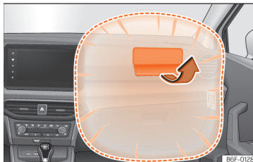
SL 15 Sovoznikova varnostna blazina v armaturni plošči.
