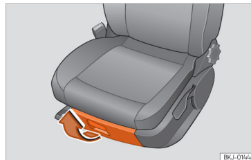
SL. 115 Predal pod desnim sprednjim sedežem.
