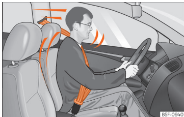
Sl. 7 Pripet voznik, ki ga ob nenadnem sunkovitem zaviranju zadrži pravilno pripet varnostni pas.
