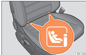
Sl. 33 Sovoznikov sedež: sidrni točki sistema ISOFIX/i-Size.
