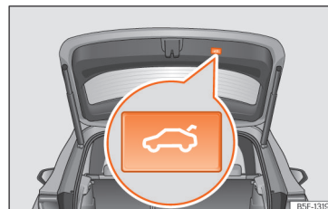
Sl. 93 Vrata prtljažnika: tipka za zapiranje vrat prtljažnika.
