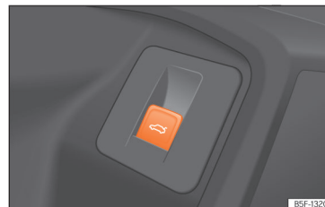
Sl. 94 Voznikova vrata: tipka za odpiranje in zapiranje vrat prtljažnika.
