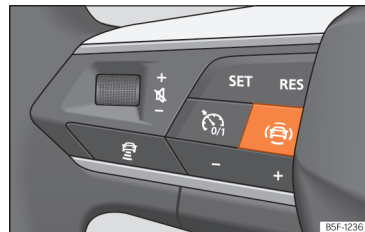
Sl. 73 Leva stran večfunkcijskega volana: tipka za asistenčne sisteme (odvisno od izvedbe).
