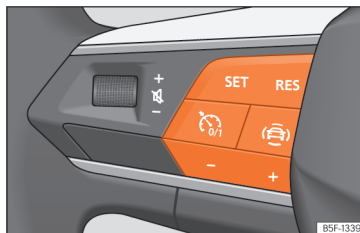
Sl. 174 Na večfunkcijskem volanu: tipke za upravljanje omejevalnika hitrosti.
