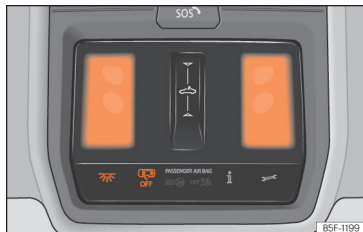
Sl. 104 Del stropne obloge: notranja osvetlitev spredaj
