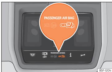
Sl. 21 V stropni konzoli: kontrolna lučka za deaktivirano sovoznikovo čelno varnostno blazino.
