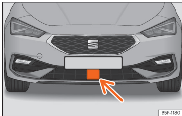
Sl. 167 V sprednjem odbijaču: radarski senzor
