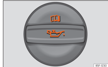
Sl. 225 V motornem prostoru: pokrov odprtine za dolivanje motornega olja v motornem prostoru.
