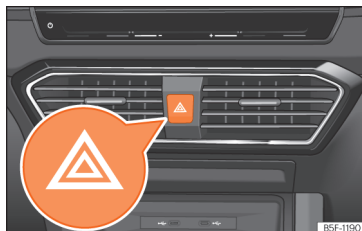
Sl. 103 Armatura plošča: stikalo za opozorilne utripalke
