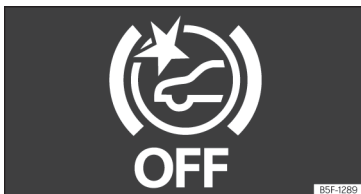
Sl. 178 Na zaslonu kombiniranega instrumenta: sporočilo o izklopu sistema Front Assist
