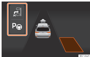
Sl. 197 Na zaslonu kombiniranega instrumenta: vizualizacija parkirne krmilne asistencije z miniaturnimi prikazi.
