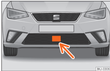
Sl. 142 V sprednjem odbijaču: radarski senzor
