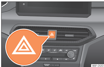
Sl. 98 Armaturna plošča: stikalo za opozorilne utripalke
