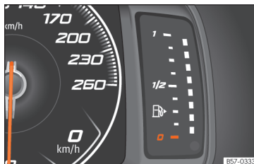
Sl. 67 Digitalni kombinirani instrument: prikazovalnik količine goriva.
