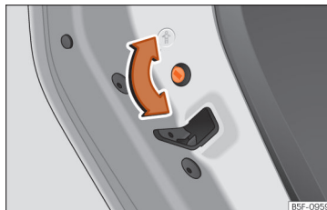
SL 89 Otroška blokada v levih vratih
