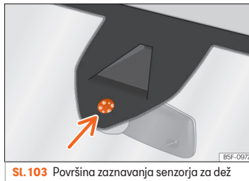
Sl. 103 Površina zaznavanja senzorja za dež
