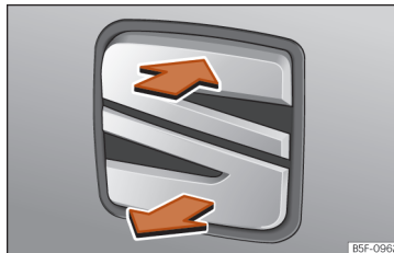
Sl. 90 Vrata prtljažnika: odpiranje z zunanje strani.
