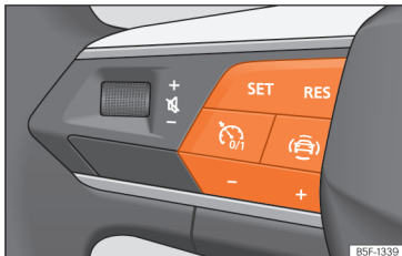
Sl. 149 Na večfunkcijskem volanu: tipke za upravljanje omejevalnika hitrosti.
