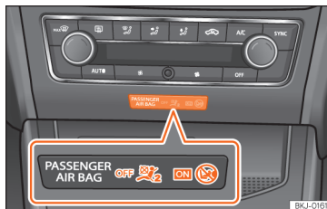
Sl. 17 Sredinski del armaturne plošče: kontrolna lučka za deaktivirano sovoznikovo čelno varnostno blazino
