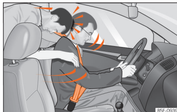
Sl. 9 Nepriprtega sopotnika na zadnjem sedalu vrže naprej v priprtega voznika.
