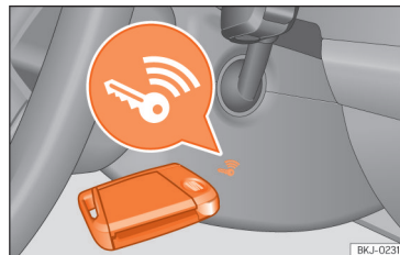
Sl. 134 Na desni strani volana: zasilni zagon
