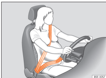
Sl. 13 Potek varnostnega pasu pri nosečnicah
