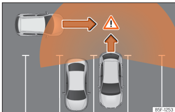
Sl. 164 Shematski prikaz delovanja opozorila na prečni promet zadaj: zaznano območje okrog vozila, ki speljuje.
