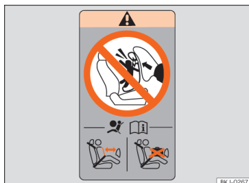
Sl. 23 Nalepka za varnostno blazino: na zadnjem okvirju sovoznikovih vrat
