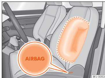
Slika 32 Stranska varnostna blazina v voznikovem sedežu.
