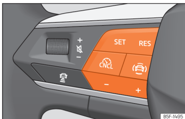
Slika 134 Na večfunkcijskem volanu: tipke za upravljanje omejevalnika hitrosti.
