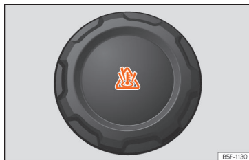
Slika 227 Prostor spredaj: pokrov ekspanzijske posode s hladilno tekočino.
