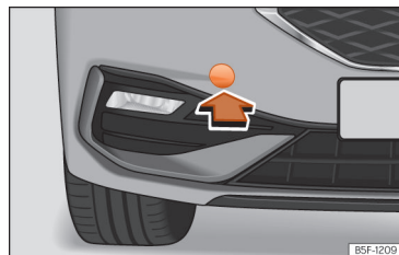
Slika 216 Na desni strani sprednjega odbijača: odstranjevanje obloge.
