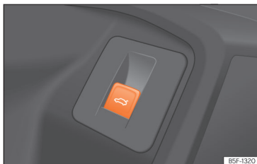
Slika 82 Voznikova vrata: tipka za odpiranje in zapiranje vrat prtljažnika.
