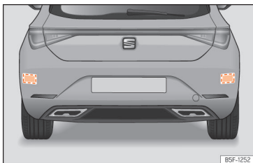
Slika 130 Območje za vozilom: območja radarskih senzorjev
