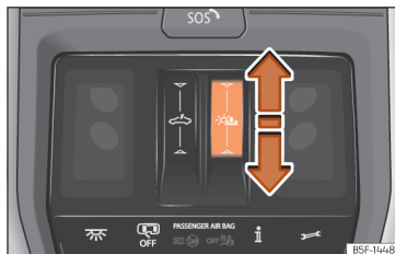
Slika 89 V stropni oblogi: upravljanje senčnega roloja.
