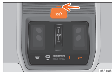
Slika 49 V stropni konzoli: elementi upravljanja za glasovne storitve.
