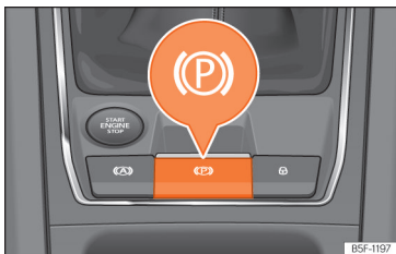
Slika 151 Sredinska konzola, spodnji del: tipka za elektronsko parkirno zavoro.
