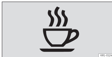
Slika 7 Na zaslonu kombiniranega instrumenta: simbol asistencije za zaznavanje utrujenosti.
