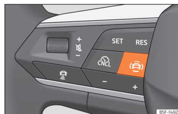
Slika 126 Leva stran večfunkcijskega volana: tipka za asistenčne sisteme (odvisno od izvedbe).
