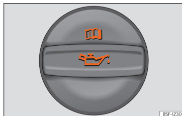
Slika 234 Pokrov odprtine za dolivanje motornega olja v motornem prostoru.
