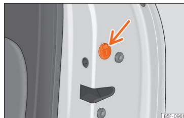
Slika 78 Zasilno zaklepanje vrat.
