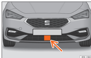
Slika 127 V sprednjem odbijaču: radarski senzor.
