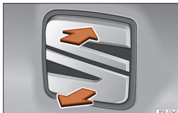
Slika 80 Vrata prtljažnika: odpiranje z zunanje strani.
