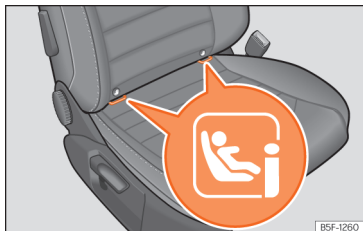
Slika 41 Sovoznikov sedež: lokacija sidrnih točk sistema i-Size.
