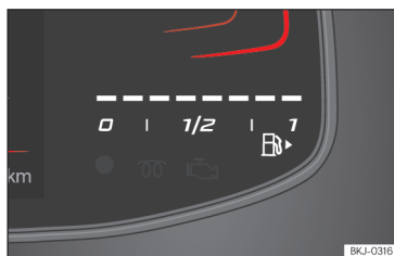
Slika 3 Osnovni kombinirani instrument: prikazovalnik količine goriva.
