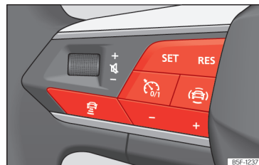
Slika 102 Na večfunkcijskem volanu: tipke za upravljanje tempomata ACC.
