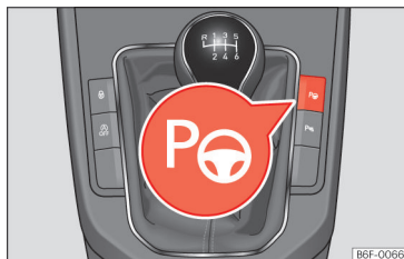
Slika 123 V sredinski konzoli: tipka za vklop parkirne asistencie s krmilno avtomatiko
