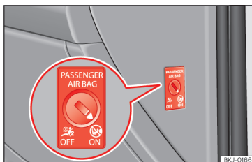
Slika 27 Stikalo za aktiviranje in deaktiviranje sovoznikove čelne varnostne blazine.
