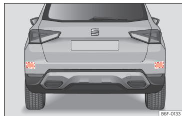
Slika 95 Območje za vozilom: območja radarskih senzorjev
