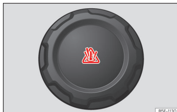
Slika 180 Prostor spredaj: pokrov ekspanzijske posode s hladilno tekočino.
