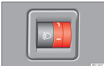
Slika 70 Ob volanu: stikalo za nastavitev svetlobnega snopa luči.
