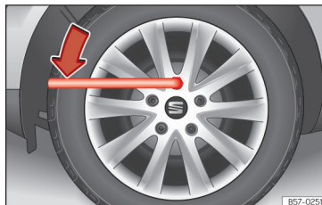
Slika 195 Menjava kolesa: odvijanje kolesnih vijakov.
