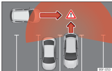
Slika 130 Shema parkirnega sistema: zaznano območje okrog vozila, ki speljuje.
