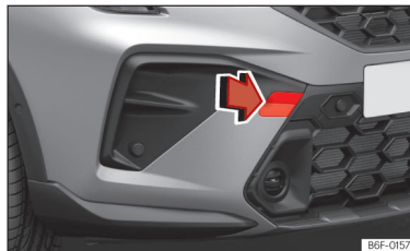
Slika 163 Na desni strani sprednjega odbijača: odstranjevanje obloge.
