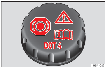
Slika 181 Motorni prostor: pokrovček posode z zavorno tekočino.
