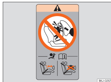
Slika 34 Nalepka z informacijami o varnostni blazini: na dnu okvirja sovoznikovih vrat.
