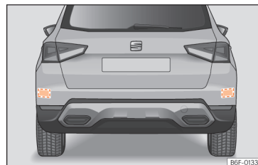
Slika 95 Območje za vozilom: območja radarskih senzorjev
