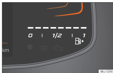
Slika 3 Osnovni kombinirani instrument: prikazovalnik količine goriva.
