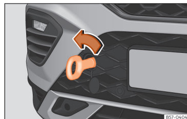
Slika 195 Sprednji odbijač desno: privito vlečno uho
