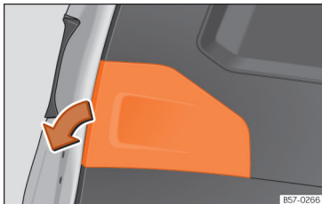
Slika 202 Odprta vrata prtljažnika: snemanje obloge.
