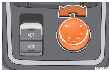
Slika 105 Sredinska konzola: vrtljivi gumb Driving Experience.
