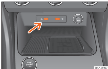
Slika 157 Sredinska konzola: USB-priključek.
