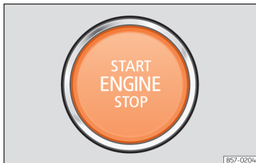
Slika 97 V spodnjem predelu sredinske konzole: zagonsko stikalo
