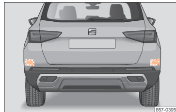
Slika 111 Območje za vozilom: območja radarskih senzorjev
