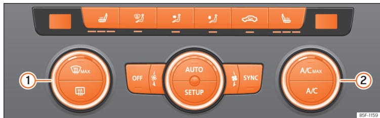
Slika 92 V vredinski konzoli: enota za upravljanje Climatronica.
