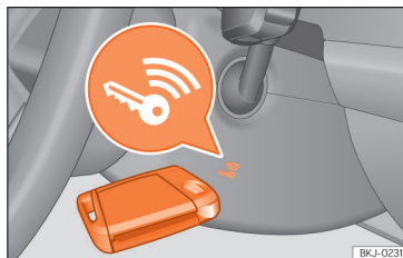
Slika 98 Na desni strani volana: zasilni zagon
