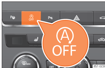
SL 160 Sredinska konzola: sistemska tipka start-stop
