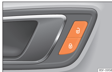
SL 90 Voznikova vrata: tipka za centralno zaklepanje.
