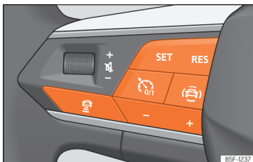
Sl. 180 Na večfunkcijskem volanu: tipke za upravljanje tempomata ACC
