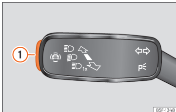
Sl. 77 Na ročici za smernike in dolge luči: tipka za asistenčne sisteme (odvisno od izvedbe).
