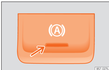
Sl. 195 V spodnjem delu sredinske konzole: tipka za funkcijo Auto Hold.
