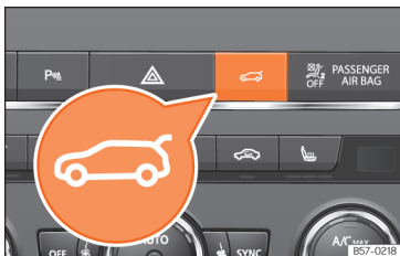
Sl. 99 Sredinska konzola: tipka za odpiranje in zapiranje vrat prtljažnika.
