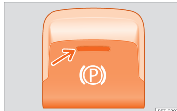
Sl. 194 V spodnjem delu sredinske konzole: tipka za elektronsko parkirno zavoro.
