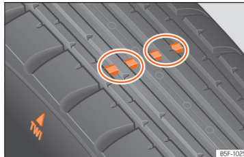
Sl. 230 Profil pnevmatike: oznake obrabljenosti
