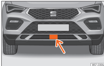
Sl. 167 V sprednjem odbijaču: radarski senzor
