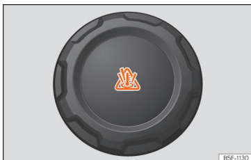
Sl. 225 Motorni prostor: pokrov ekspanzijske posode s hladilno tekočino
