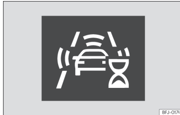
SL. 179 Na zaslonu kombiniranega instrumenta: prikaz pri začetnem samodejnem kalibriranju sistema
