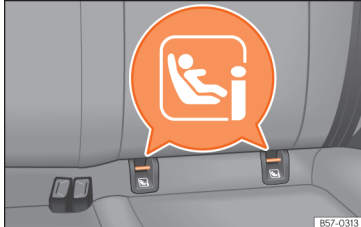
Sl. 26 Zadnji sedež: sidrni točki sistema ISOFIX/i-Size.
