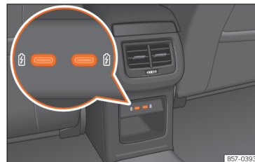
Sl. 156 Zadnji del sredinske konzole: USB-priključek s funkcijo vtičnice.
