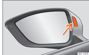
SL. 189 Kontrolna lučka asistencije za opozarjanje na vozila v mrtvem kotu.
