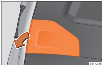
Sl. 61 Odprta vrata prtljažnika: snemanje obloge.
