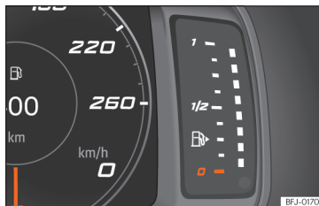
Sl. 72 Digitalni kombinirani instrument: prikazovalnik količine goriva.
