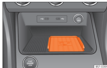
SL 154 Sredinska konzola: mesto za priključitev mobilnega telefona
