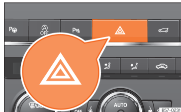
SL 110 Armaturna plošča: stikalo za opozorilne utripalke
