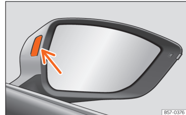
SL. 190 Kontrolna lučka asistencije za opozarjanje na vozila v mrtvem kotu.
