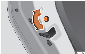
Sl. 96 Otroška blokada v levih vratih
