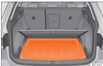
Sl. 129 V prtljažniku: shranjevanje zadnje police pod dno prtljažnika.
