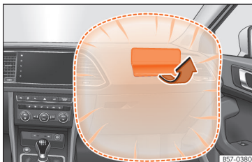
Sl. 15 Sovoznikova varnostna blazina v armaturni plošči.
