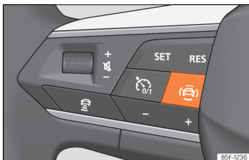
Sl. 78 Leva stran večfunkcijskega volana: tipka za asistenčne sisteme (odvisno od izvedbe).
