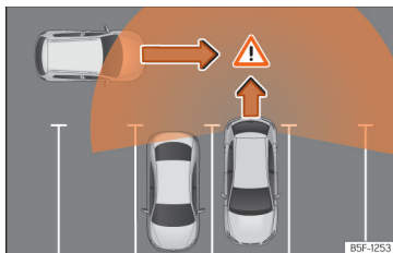
Sl. 193 Shematski prikaz delovanja opozorila na prečni promet zadaj: zaznano območje okrog vozila, ki speljuje.
