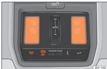
Sl. 105 Del stropne obloge: notranja osvetlitev spredaj
