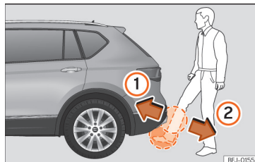
Sl. 87 Senzorsko krmiljeno odpiranje/zapiranje vrat prtljažnika (Easy Open)
