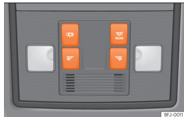
SL. 97 Del stropne obloge: notranja osvetlitev spredaj
