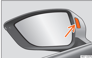
Sl. 195 Kontrolna lučka asistencije za opozarjanje na vozila v mrtvem kotu.
