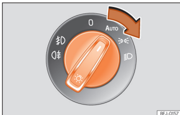
Sl. 93 Armaturna plošča: stikalo za luči.
