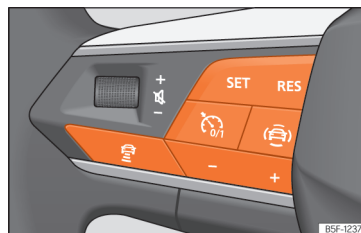
SL 186 Na večfunkcijskem volanu: tipke za upravljanje tempomata ACC
