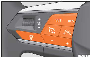
Sl. 194 Leva stran večfunkcijskega volana: tipke za upravljanje asistence Travel Assist.
