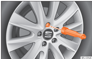
Sl. 39 Menjava kolesa: popuščanje kolesnih vijakov z nastavkom v ročaju izvijača.
