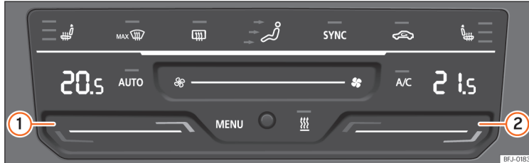
Sl. 147 V sredinski konzoli: elementi za upravljanje Climatronica
