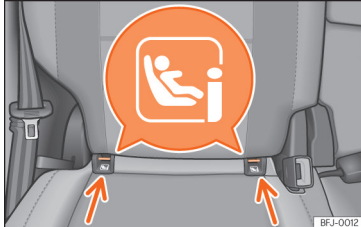
Sl. 26 Stranska sedeža v drugi vrsti: sidrni točki sistema ISOFIX/i-Size.
