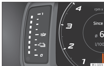
Sl. 60 Kombinirani instrument: prikaz stanja napolnjenosti baterije.
