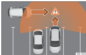
Sl. 199 Shematski prikaz delovanja opozorila na prečni promet zadaj: zaznano območje okrog vozila, ki speljuje.
