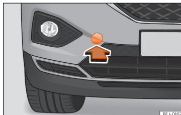
Sl. 45 Sprednji odbijač desno: pokrovček.
