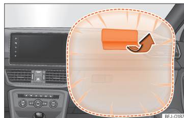
Sl. 16 Sovoznikova varnostna blazina v armaturni plošči.
