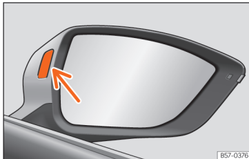
Sl. 196 Kontrolna lučka asistencije za opozarjanje na vozila v mrtvem kotu.
