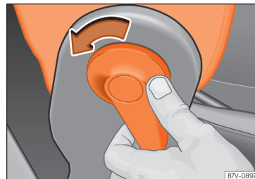
SL 114 Sproščanje poklopnega naslonjala sovoznikovega sedeža.
