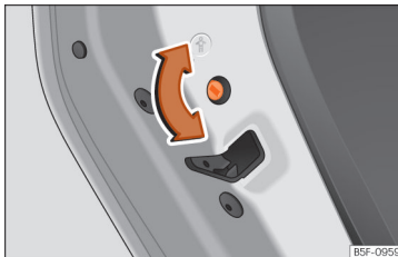
Sl. 83 Otroška blokada v levih vratih
