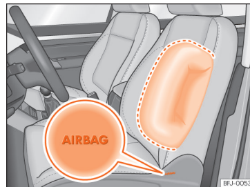
Sl. 21 Stranska varnostna blazina v voznikovem sedežu.
