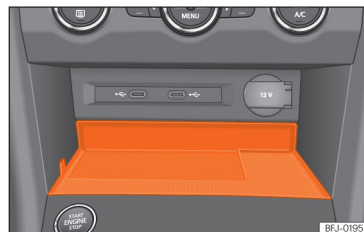
SL 161 Sredinska konzola: mesto za priključitev mobilnega telefona
