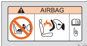
Sl. 24 Nalepka za varnostno blazino: na sovoznikovem senčniku
