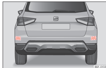
Slika 96 Območje za vozilom: območja radarskih senzorjev
