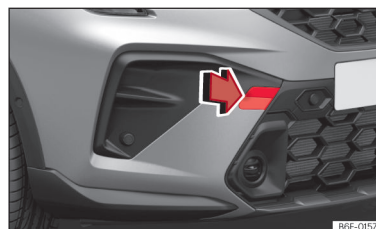
Slika 164 Na desni strani sprednjega odbijača: odstranjevanje obloge.
