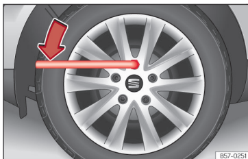
Slika 196 Menjava koles: odvijanje kolesnih vijakov.
