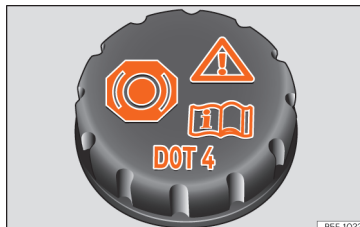
Sl. 190 Motorni prostor: pokrovček posode z zavorno tekočino.
