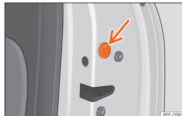
Sl. 91 Zasilno zaklepanje vrat.
