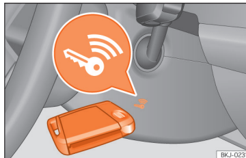
Sl. 138 Na desni strani volana: zasilni zagon
