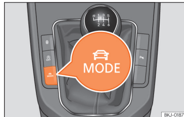
Sl. 145 Poleg prestavne ročice: tipka MODE
