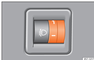
Sl. 102 Ob volanu: stikalo za nastavitev svetlobnega snopa luči.
