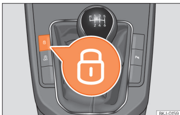
Sl. 86 Sredinska konzola: tipka centralnega zaklepanja
