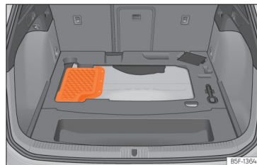
Sl. 237 Hibridna vozila (PHEV): akumulator v prtljažniku
