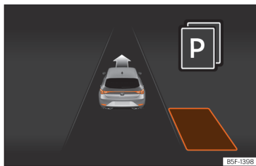
Slika 151 Na zaslonu kombiniranega instrumenta: vizualizacija parkirne asistencije s krmilno avtomatiko z miniaturnimi prikazi
