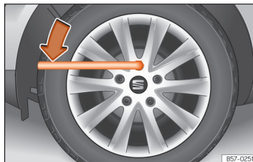
Slika 240 Menjava kolesa: odvijanje kolesnih vijakov.
