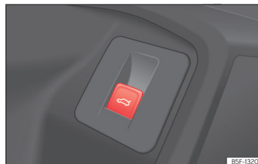
Slika 81 Voznikova vrata: tipka za odpiranje in zapiranje vrat prtljažnika.
