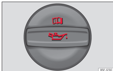
Slika 250 Pokrov odprtine za dolivanje motornega olja v motornem prostoru.
