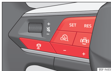
Slika 137 Na večfunkcijskem volanu: tipke za upravljanje tempomata ACC.
