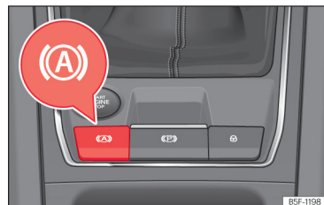
Slika 153 V spodnjem delu sredinske konzole: tipka za funkcijo Auto Hold.
