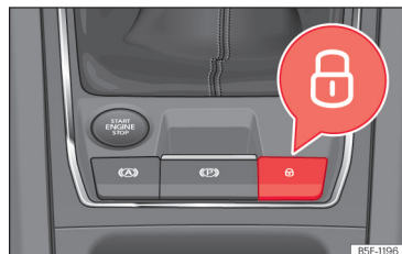
Slika 76 Na sredinski konzoli: tipka centralnega zaklepanja
