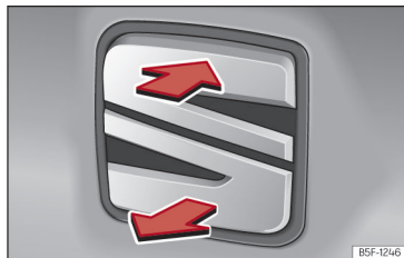
Slika 80 Vrata prtljažnika: odpiranje z zunanje strani.
