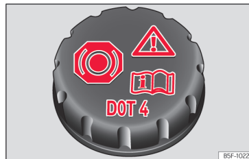
Slika 244 Motorni prostor: pokrovček posode z zavorno tekočino.
