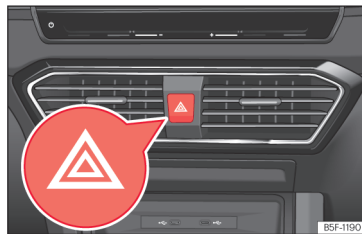
Slika 48 Armaturna plošča: tipka za opozorilne utripalke
