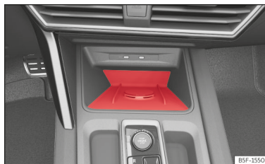
Slika 186 Na sredinski konzoli: mesto za priključitev mobilnega telefona.
