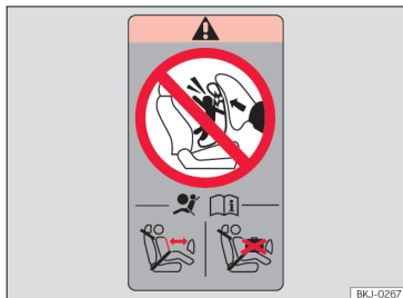
Slika 39 Nalepka z informacijami o varnostni blazini: na zadnjem okvirju sovoznikovih vrat.
