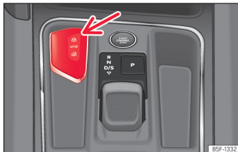
Slika 69 Sredinska konzola (z avtomatskim menjalnikom): ohišje za ključ vozila.
