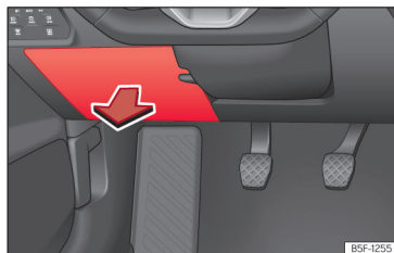
Slika 235 Na voznikovi strani v armaturni plošči: pokrov postaje z varovalkami.
