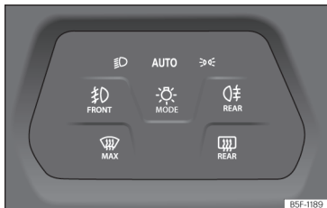
Slika 104 Armaturna plošča: stikalo za upravljanje luči.
