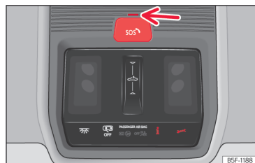
Slika 49 V stropni konzoli: elementi za upravljanje za glasovne storitve.
