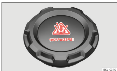
Slika 241 Motorni prostor: pokrov ekspanzijske posode s hladilno tekočino
