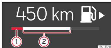
Slika 3 Prikazovalnik količine goriva na različnih lokacijah glede na prikaz.
