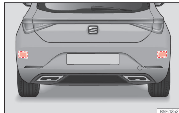
Slika 130 Območje za vozilom: območje radarskih senzorjev
