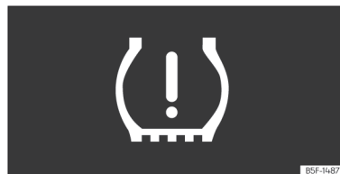
Slika 266 Kombinirani instrument: opozorilo na izgubo tlaka v pnevmatiki.
