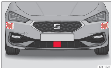
Slika 127 V sprednjem odbijaču: radarski senzorji spredaj in na strani
