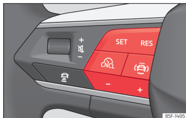
Slika 133 Na večfunkcijskem volanu: tipke za upravljanje tempomata.
