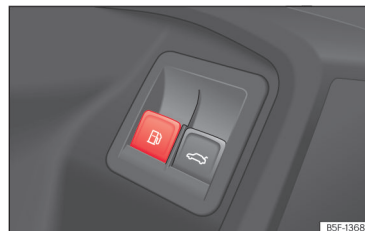
Slika 219 Voznikova vrata: odklepanje lopute rezervoarja za gorivo.
