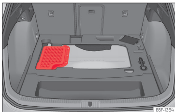
Slika 251 Hibridna vozila (PHEV): mesto vgradnje akumulatorja v prtljažniku.
