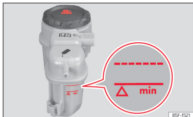
Slika 243 V motornem prostoru: ekspanzijska posoda s hladilno tekočino.
