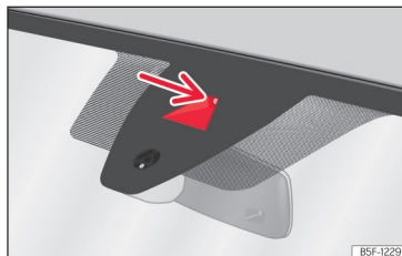
Slika 129 V vetrobranskem steklu: vidno polje kamere asistencence za ohranjanje smeri.
