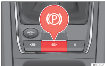
Slika 152 Sredinska konzola, spodnji del: tipka za elektronsko parkirno zavoro.
