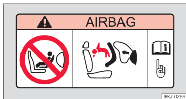
Slika 38 Nalepka z informacijami o varnostni blazini: na sovoznikovem senčniku.
