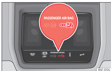
Slika 29 V stropni konzoli: kontrolna lučka za deaktivirano sovoznikovo varnostno blazino.
