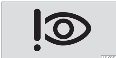
Slika 8 Na zaslonu kombiniranega instrumenta: Simbol za opozorilo za pozornost
