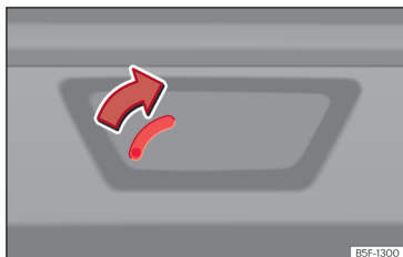
Slika 85 Prtljažnik: mehanizem za zasilno odklepanje (Leon Sportstourer).
