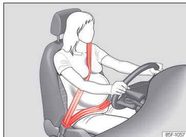
Slika 25 Potek varnostnega pasu pri nosečnicah
