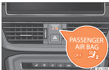
Slika 34 Armaturna plošča: kontrolna lučka za izključeno sovoznikovo čelno varnostno blazino v sredinski konzoli.
