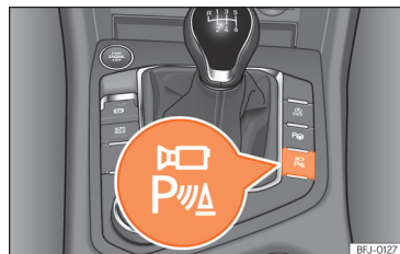
Slika 171 Sredinska konzola: tipka za ročni ročni vklop/izklop sistema kamer za pogled od zgoraj (Top View) v povezavi s parkirno krmilno asistenco.
