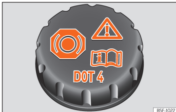
Sl. 227 Motorni prostor: pokrovček posode z zavorno tekočino.
