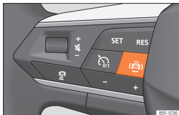
Sl. 61 Leva stran večfunkcijskega volana: tipka za asistenčne sisteme (odvisno od izvedbe).
