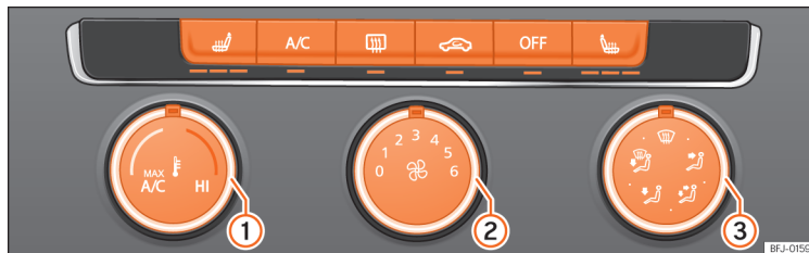
SL 144 V sredinski konzoli: elementi za upravljanje ročne klimatske naprave.
