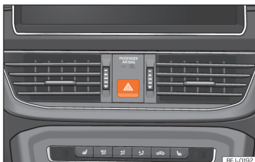
Sl. 92 Armaturna plošča: stikalo za opozorilne utripalke
