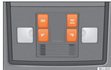
Sl. 93 Del stropne obloge: notranja osvetlitev spredaj
