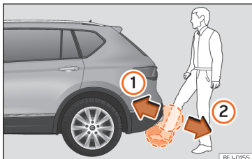
Sl. 83 Senzorsko krmiljeno odpiranje/zapiranje vrat prtljažnika (Easy Open)
