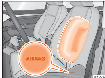
Sl. 21 Stranska varnostna blazina v voznikovem sedežu.
