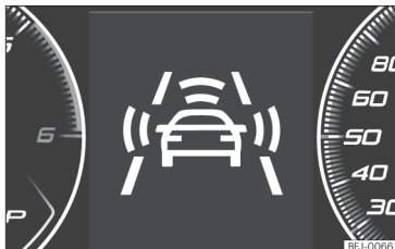
Sl. 177 Na zaslonu kombiniranega instrumenta: prikaz predhodnega opozorila
