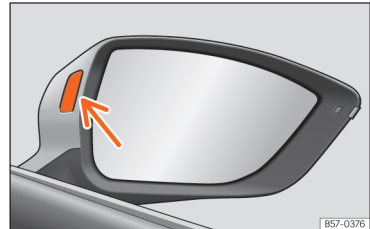
SL. 190 Kontrolna lučka asistenc za opozarjanje na vozila v mrtvem kotu.
