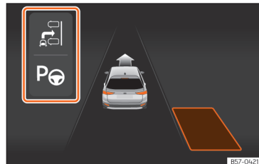
Sl. 197 Na zaslonu kombiniranega instrumenta: vizualizacija parkirne krmlilne asistence z miniaturnimi prikazi.
