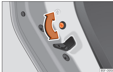
Sl. 79 Otroška blokada v levih vratih
