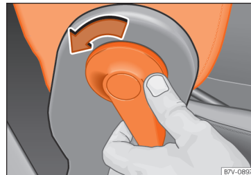
Sl. 110 Sproščanje poklopnega naslonjala sovoznikovega sedeža.
