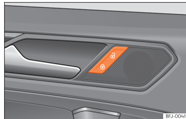
Sl. 73 Voznikova vrata: tipka za centralno zaklepanje.
