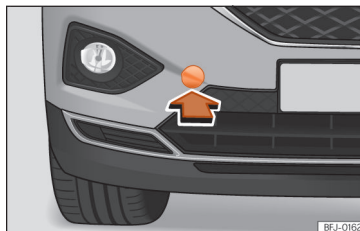
Sl. 45 Sprednji odbijač desno: pokrovček.
