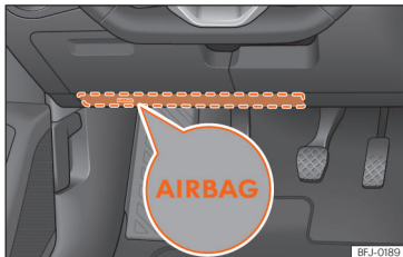
Sl. 19 Na voznikovi strani: mesto vgradnje kolenske varnostne blazine.
