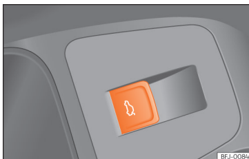
Sl. 82 Voznikova vrata: tipka za odpiranje in zapiranje vrat prtljažnika.
