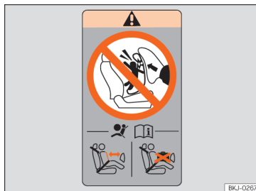
Sl. 25 Nalepka za varnostno blazino: na zadnjem okvirju sovoznikovih vrat
