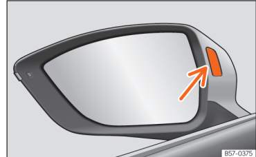
SL. 189 Kontrolna lučka asistenc za opozarjanje na vozila v mrtvem kotu.
