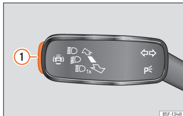
Sl. 60 Na ročici za smernike in dolge luči: tipka za asistenčne sisteme (odvisno od izvedbe).
