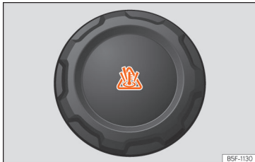
Sl. 226 Motorni prostor: pokrov ekspanzijske posode s hladilno tekočino
