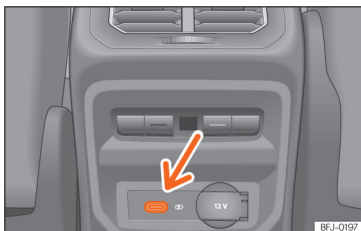
Sl. 157 Zadnji del sredinske konzole: USB-priključek s funkcijo vtičnice.
