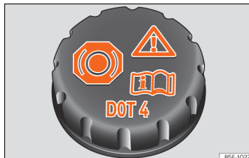
Sl. 216 Motorni prostor: pokrovček posode z zavorno tekočino.
