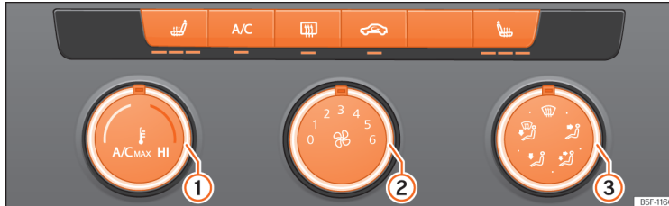
Sl. 135 V sredinski konzoli: elementi za upravljanje ročne klimatske naprave.
