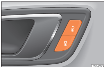
Sl. 79 Voznikova vrata: tipka za centralno zaklepanje.
