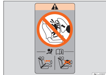
Sl. 25 Nalepka za varnostno blazino: na zadnjem okvirju sovoznikovih vrat
