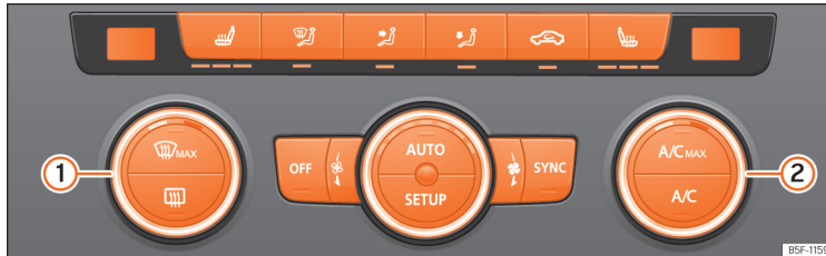
Sl. 134 V sredinski konzoli: elementi za upravljanje Climatronica
