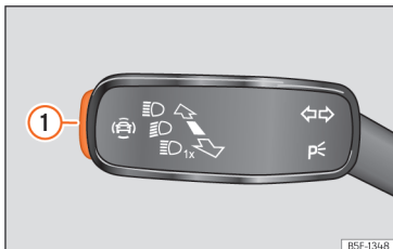
Sl. 65 Na ročici za smernike in dolge luči: tipka za asistenčne sisteme (odvisno od izvedbe).
