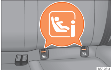
Sl. 26 Zadnji sedež: sidrni točki sistema ISO-FIX/i-Size.
