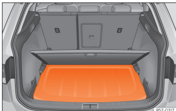
Sl. 118 V prtlačniku: shranjevanje zadnje police pod dno prtlačnika.
