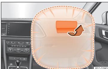
Sl. 15 Sovoznikova varnostna blazina v armaturni plošči.
