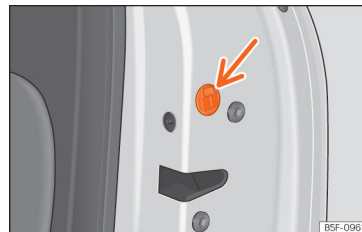
Sl. 84 Zasilno zaklepanje vrat.
