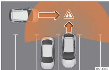
Sl. 181 Shematski prikaz delovanja opozorila na prečni promet zadaj: zaznano območje okrog vozila, ki speljuje.
