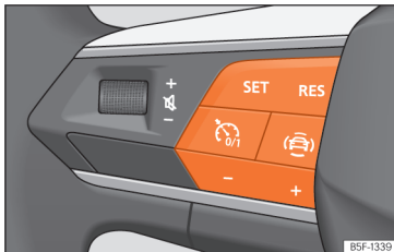
Sl. 164 Na večfunkcijskem volanu: tipke za upravljanje omejevalnika hitrosti.
