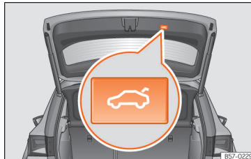
Sl. 87 Vrata prtljažnika: tipka za zapiranje vrat prtljažnika.
