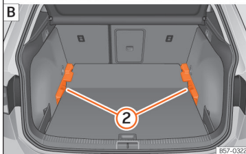
Sl. 119 Variabilno dno prtlačnika: [A] zgornji položaj; [B] spodnji položaj
