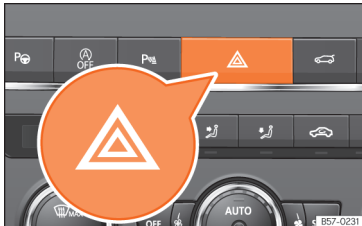
Sl. 99 Armaturna plošča: stikalo za opozorilne utripalke
