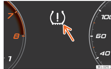
Sl. 221 Kombinirani instrument: opozorilo na izgubo tlaka v pnevmatiki.
