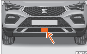
Sl. 157 V sprednjem odbijaču: radarski senzor
