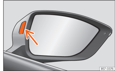
Sl. 178 Kontrolna lučka asistence za opozarjanje na vozila v mrtvem kotu.
