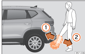
Sl. 89 Senzorsko krmiljeno odpiranje/zapiranje vrat prtljažnika (Easy Open)
