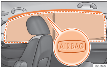
St. 22 Mesto vgradnje varnostne blazine za glavo
