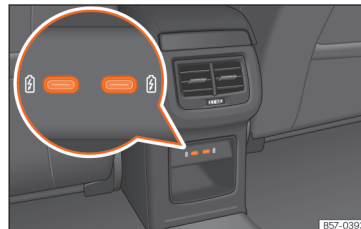
Sl. 147 Zadnji del sredinske konzole: USB-priključek s funkcijo vtičnice.
