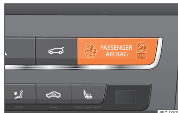
Sl. 17 Armaturna plošča: kontrolna lučka za deaktivirano sovoznikovo čelno varnostno blazino.
